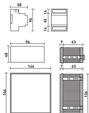
I modelli B20-AS1A e B20-AS2A sono centrali per installazione su barra DIN (3 moduli) alle quali è possibile collegare rispettivamente 1 o 2 rivelatori FLY o WPD/CA3.
