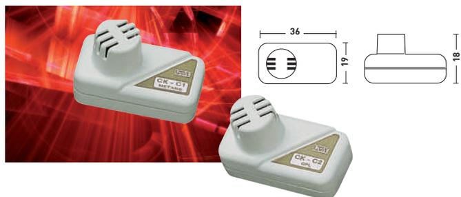
I moduli sensore CK con sensore catalitico offrono un elevato grado di selettività agli agenti interferenti e sono dotati di una memoria permanente nella quale sono inseriti i parametri di produzione: tipo di gas, concentrazione di taratura, data di produzione, numero di serie, ecc. Il rivelatore utilizza inoltre la memoria del modulo CK per registrare le ore di funzionamento del sensore.
