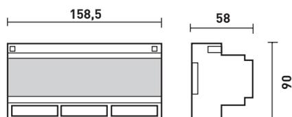
MODULA 8 è un'unità di controllo programmabile fino ad 8 zone 4÷20 mA per il monitoraggio continuo della presenza nell'aria ambiente di gas tossici, gas combustibili e della deficienza d'ossigeno.
