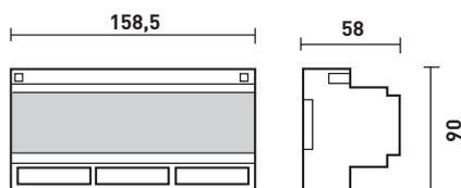
La MODULA 4 è una centrale di rivelazione specificatamente progettata per poter essere utilizzata in tutte le applicazioni nell'ambito del monitoraggio ed il controllo d'aree da proteggere da fughe di gas infiammabili o dalla presenza di gas tossici.
